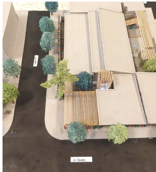
Figura 5- Quiebres de los techos para permitir ingreso del sol en invierno en todos los ambientes.
