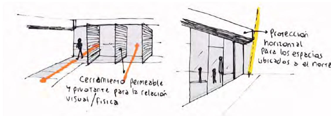
Fig. 32 y 33. Exploraciones espaciales de materialidad respetando las relaciones propuestas funcionales y de asoleamiento. Esquema cierre/vinculación patio de juegos con plaza de acceso. Alero de asoleamiento.
