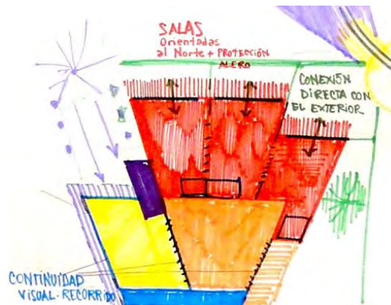
Fig. 7. Esquema en planta de la zonificación del programa y los espacios de conexión.
