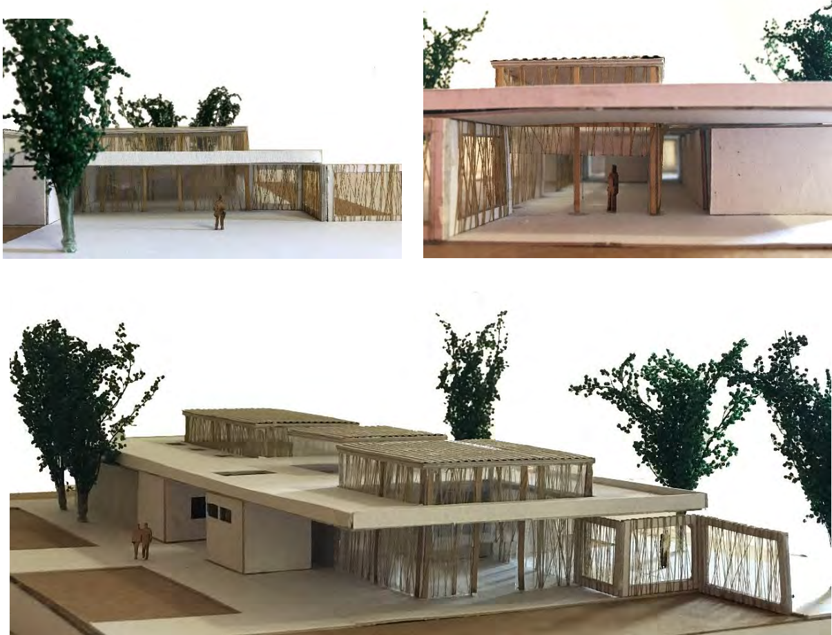
Fig. 32, 33 y 34. Maqueta 1:100. Se observan las transiciones y la relación con los espacios exteriores. Se aprecian los volúmenes vidriados con su materialidad que luego se repite en los distintos planos verticales para dar unidad al edificio. La cubierta es el gran elemento horizontal que unifica todo el proyecto.
