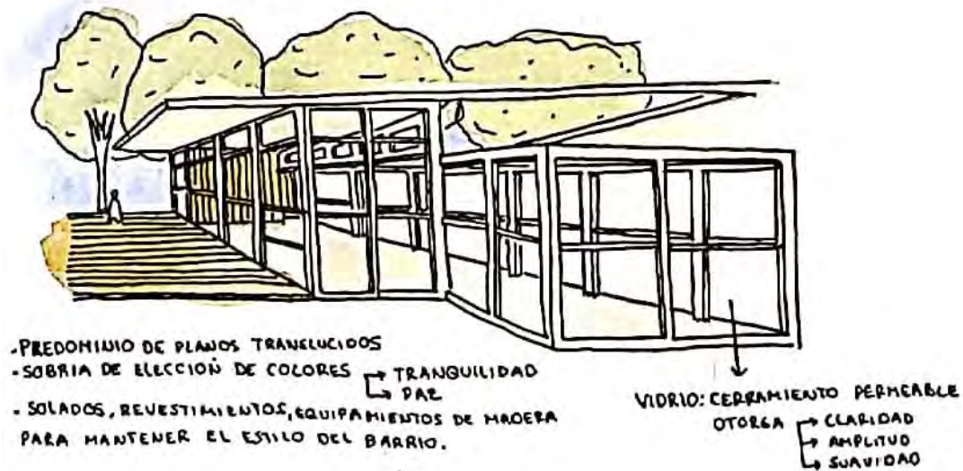
Fig. 23. Exploraciones espaciales de materialidad respetando las relaciones propuestas funcionales y de asoleamiento. Esquema cierre/vinculación con plaza de acceso. Alero de asoleamiento.
