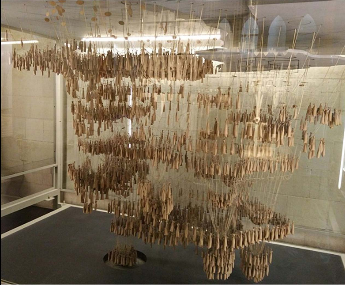
maqueta funicular de la cripta de la colonia Güell - 1898 a 1914
