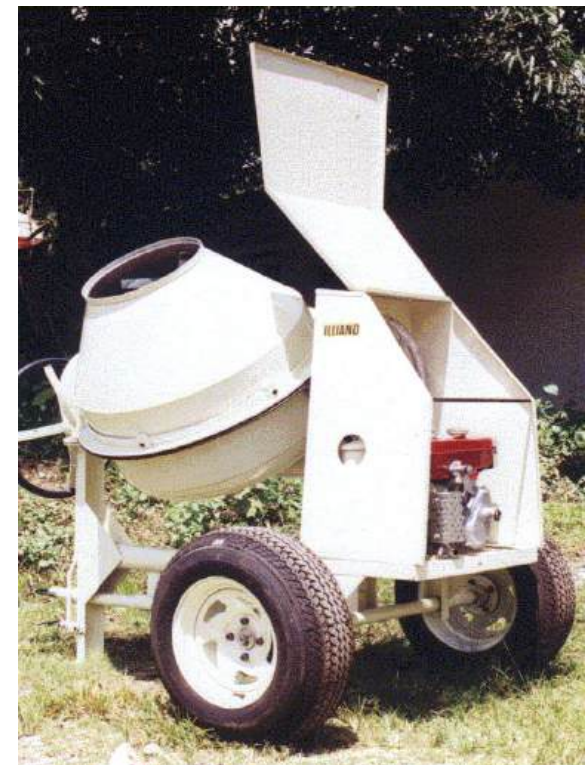
HORMIGONERA de PERA de VOLTEO 150 litros de capacidad (remolque) con motor a explosión
