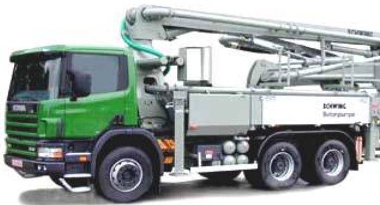
GRÚA para BOMBEO Altura: 20 m aprox. 7 pisos
