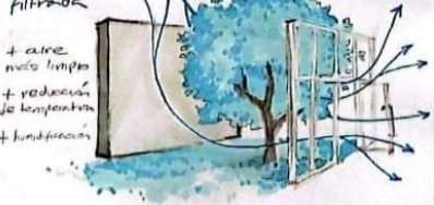
Ventilación cruzada filtrada
