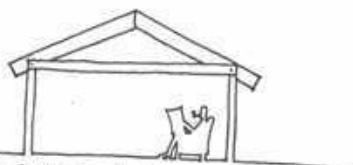
El tirante se opone al empuje horizontal
