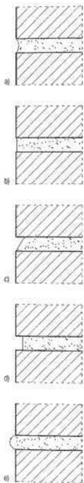
Fig. 33: Ejemplos para la formación de juntas
