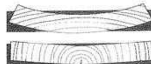
Fig. 9: Deformación de tablas durante el proceso de secado
