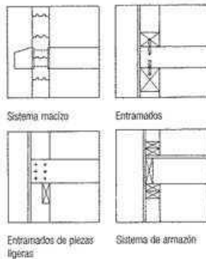
Fig. 9: Forjados de diferentes sistemas constructivos
