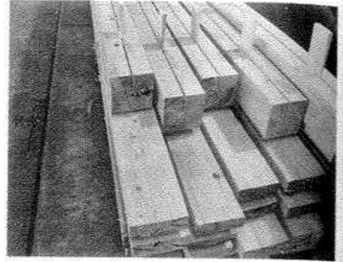
Fig. 60: Vigas con una incisión hasta el corazón y cuñas encajadas
