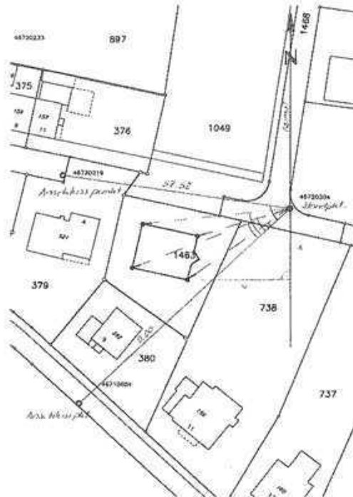
Fig. 34: Plano del catastro (plano de situación y distribución de parcelas) Esquema de un replanteo con cuatro puntos
