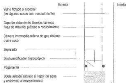
Fig. 26: Esquema constructivo de un vidrio aislante
