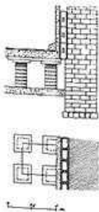
Fig. 89: Sección y planta de un hipocausto
