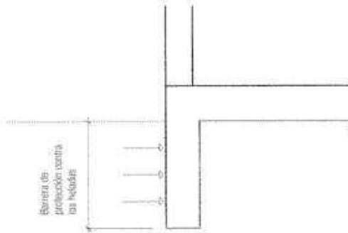
Fig. 45: Barrera de protección contra las heladas
