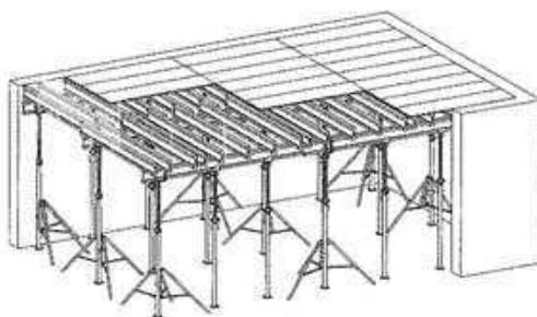
Fig. 16: Encofrado de forjados con paneles
