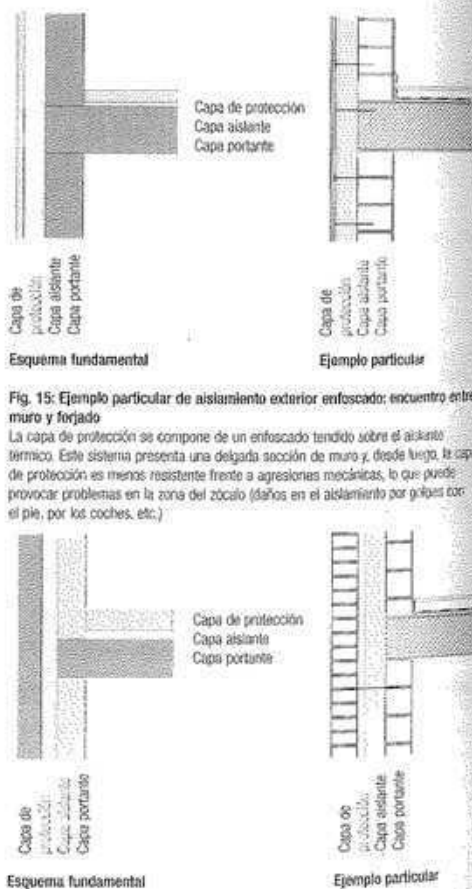
Fig. 16: Ejemplo particular de muro de dos hojas: encuentro entre muro y forjado
