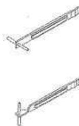
Fig. 44: Anclaje embebido en mortero en una junta vertical A Espiga embebida en el mortero B Espiga en tubo de plástico deslizante (posibilidad de dilatación)
