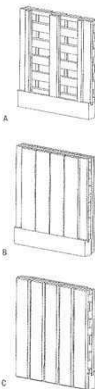
Fig. 31: Elementos para paredes Lignotrend A) con sus dos caras abiertas B) con sus dos caras cerradas C) con una cara cerrada
