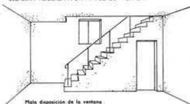
ESCALERA ADOSADA A UNA PARED DE FACHADA
