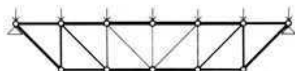
Diagonales tensadas largas y montantes comprimidos cortos
