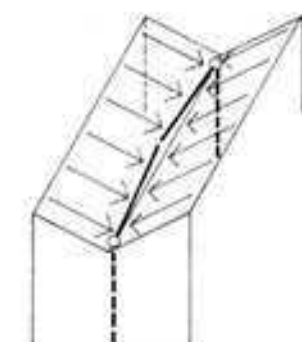
Cubierta con encuentro de vertientes con bajantes interiores
