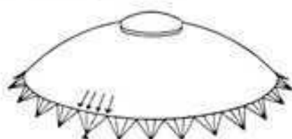
Cúpula laminar rebajada. Las fuerzas se transmiten desde el borde a un sistema de apoyos inclinados. Palazzo dello Sport, Roma
