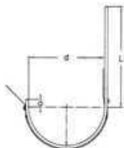
Designación de un soporte de canal galvanizado con 2 muelles. Medida normativa 125 FRH 2 Z 125
