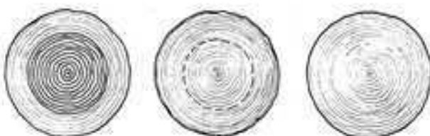
Madera de duramen Madera de duramen claro Madera de albura
