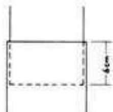
Empalme soldado con 6 cm de recubrimiento
