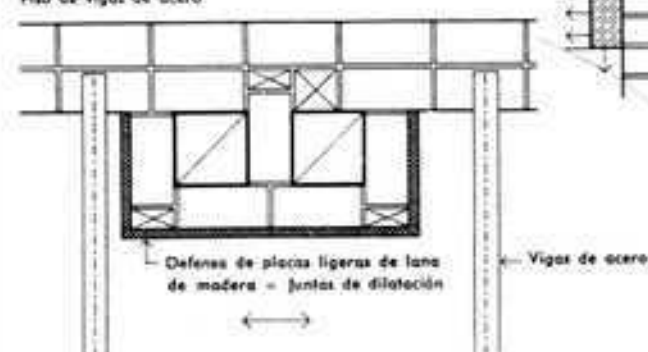
Piso de vigas de acero
