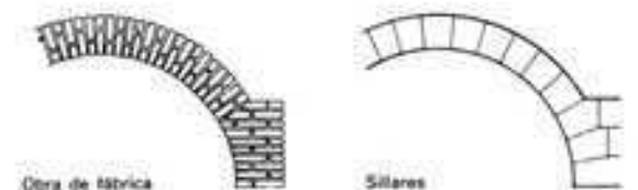
Obra de fábrica
