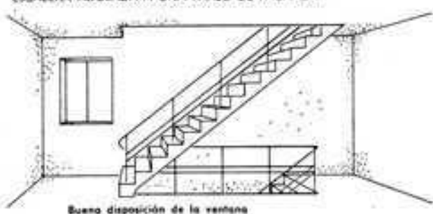
ESCALERA ADOSADA A UNA PARED DE FACHADA
