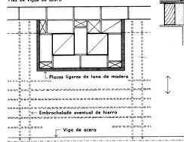
Piso de vigas de acero
