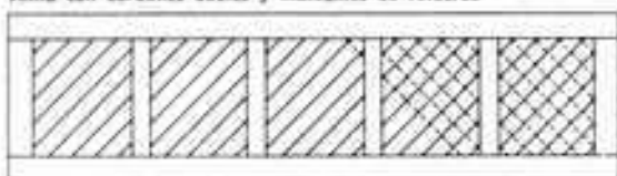
Alma con cordones dobles y montantes de refuerzo
