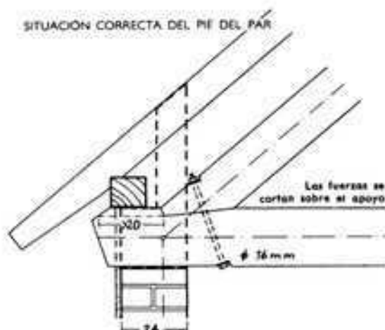
ENSAMBLE DEL PIE DEL PAR CON APOYO ESTRECHO
