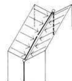
Cubierta con encuentro de vertientes con bajantes exteriores
