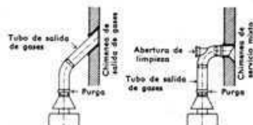
Conducción de los gases de escape a la chimenea de evacuación
