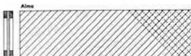
Alma con cordones dobles y montantes de refuerzo
