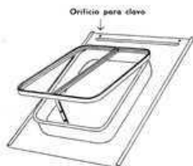
Ventana de buharda, según DIN 1110, tamaño 2
