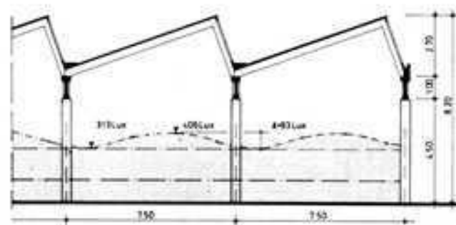
Nave con cubierta en shed con dientes de sierra
