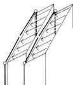
Cubierta en diente de sierra, con bajantes exteriores
