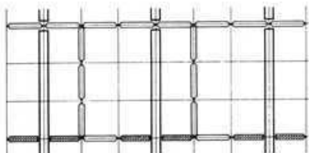
Simple superposición: dimensiones no modulares en el retículo de ejes requieren piezas de ajuste.
