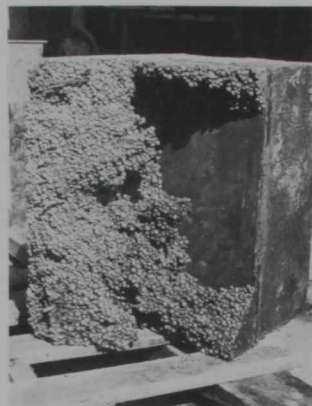
8. La eficacia del vibrado puede apreciarse en esta figura. Se formó en un cajón una capa de árido ligero y sobre ella se vertió una lechada de cemento. El macizo se separó en dos partes por una chapa de madera y se vibró el lado derecho. En este lado el cemento llegó al fondo del cajón y formó un dado compacto. En el izquierdo, la lechada sólo penetró unos centímetros.
