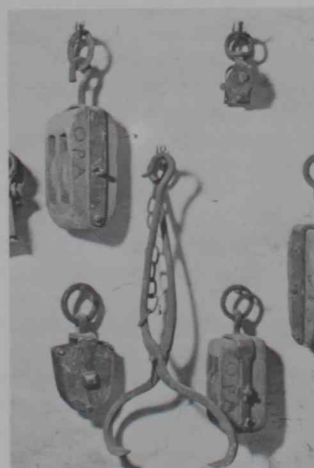
4. Uno de los sistemas de elevación que ha pervivido hasta hoy es el de las tijeras que atenazan las piezas. Se usó en Grecia (dibujo de R. Martín) y en la Italia renacentista (fotografía de herramientas del museo de Santa María dei Fiori, en Florencia).
