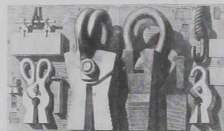
5. Las castañuelas son otra inteligente herramienta de elevación que ha llegado hasta nuestros días. El dibujo describe una castañuela griega (R. Martín) y el grabado es de Piranesi.
