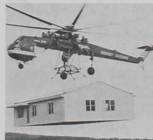
5. El sueño de la evolución tecnológica es la absoluta prefabricación, la eliminación de las operaciones en obra y la liberación de las operaciones de transporte y elevación que ofrece esta "mobile home" y su "grúa del cielo". Hace ya 40 años que Fullen soñara este sistema en el Dimaxion House.
