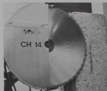
19. Las sierras de disco están revolucionando hoy el corte en obra.
