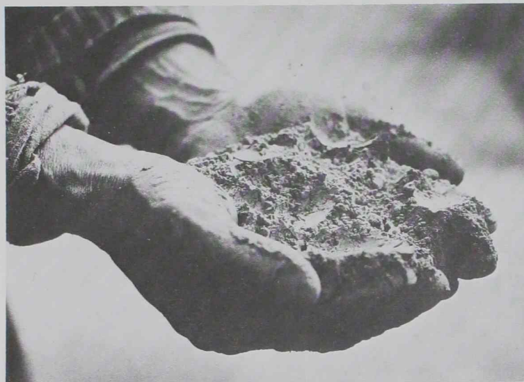
1. El cemento, como el yeso, el hormigón y otros, es un material que llega a la obra sin tener una forma específica. A este tipo de materiales los llamaremos amorfos, conformables o, según Casinello, formáceos.
