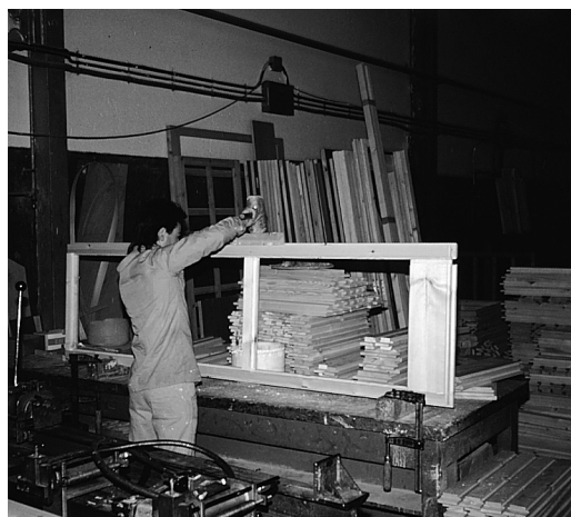
Proceso de elaboración de una puerta balconera.
