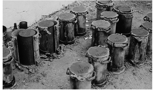
Conjunto de probetas, de 30 cm de largo y 15 cm de diámetro, de hormigón fresco recién vertido en los moldes cilíndricos.
