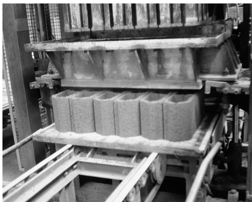
Bloques de hormigón recién moldeados para entrevigado de forjados. Su elaboración será completa cuando se haya producido el fraguado al cabo de unas horas.
