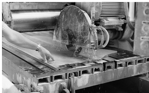
Corte con sierra de una placa en un taller de marmolistería.
