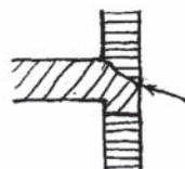
· disposición incorrecta de junta horizontal
