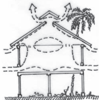
el efecto de tiraje del aire mejora la ventilación en regiones húmedas
