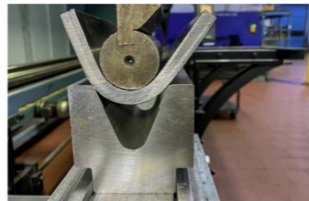
operaciones del proceso de producción -golpes-rolados-plegados
