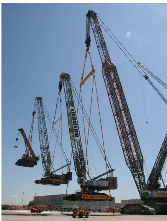
32 – Grúa LR 13000 levantando una grúa Liebherr LR 11350, una grúa LR 1350/1 y una grúa LTR 1100
