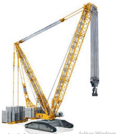
9 – Grúa sobre orugas con contrapeso propio y agregado
