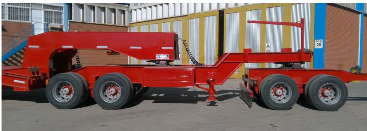
5 – carretón de carga vinculado al tractor mediante un boggie de conexión
