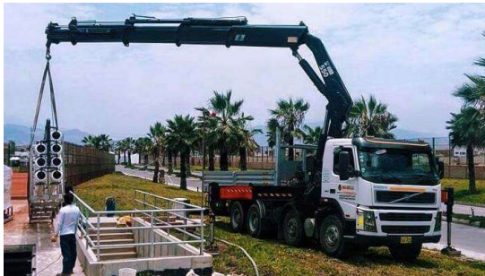
23 – grúas articulada Hiab con capacidad de hasta 20 TN.
