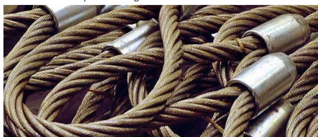
41 - eslingas de acero, trenzado de finos cordones
