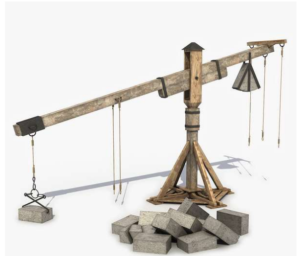
1 - Antiguo puntal de carga, basado en el uso de la palanca y un contrapeso
