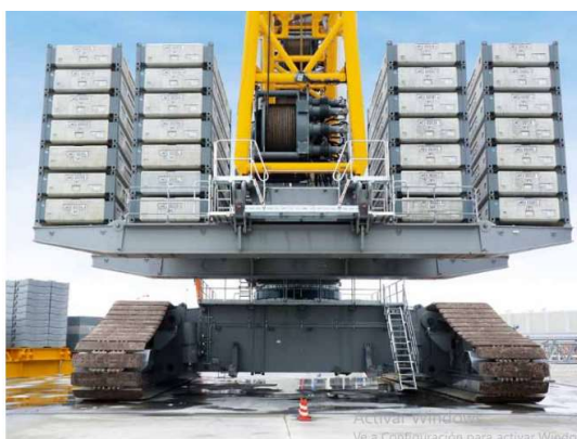
33 – carga de contrapesos máximo en estructura 750t
