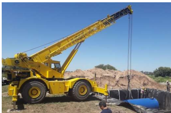
28 - Grúa Grove RT 75/S - capacidad 45t, pluma telescópica 11m, extensión 9,7m - peso total 40t - velocidad máxima 30Km, USD 115.000.
