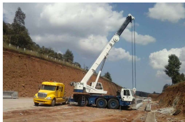
26– GRUA GROVE TM 875 - Alto 3.83m - Ancho 2.44m - Carga máxima 45t - Largo total 36.9m - Peso 36.2t -Ancho estabilizado 7.75m - Largo de pluma 27.15
