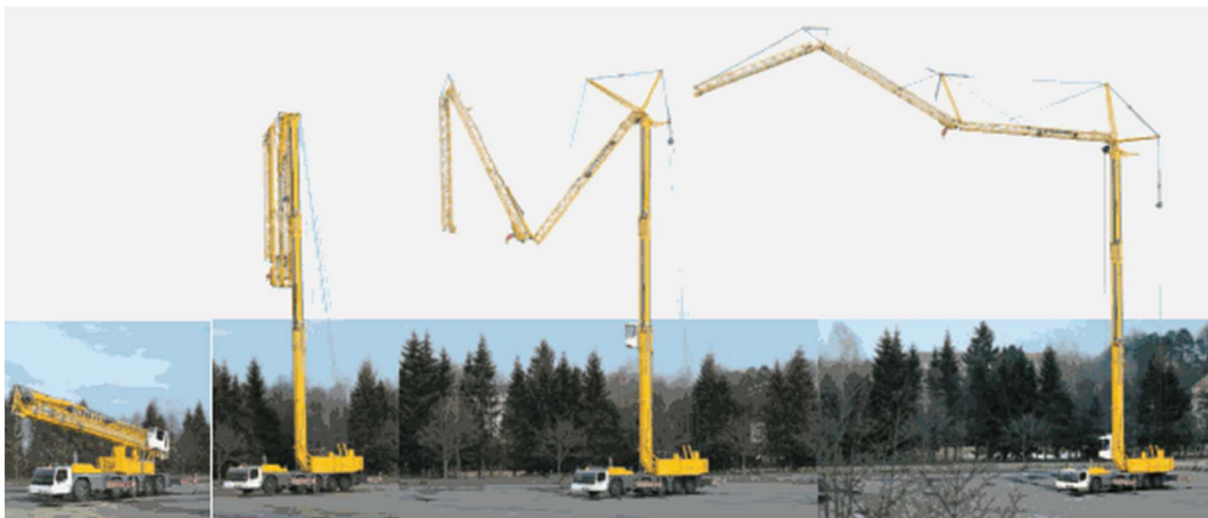
39 – grúa torre montada sobre camión
