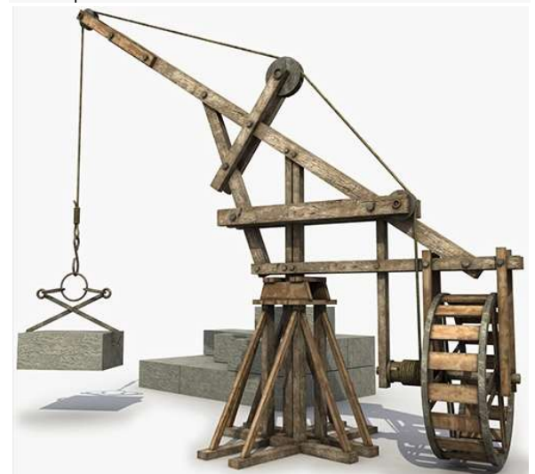
2 - Grúa aparejo romano. Los esclavos se ubicaban en la rueda para accionar la maquina
