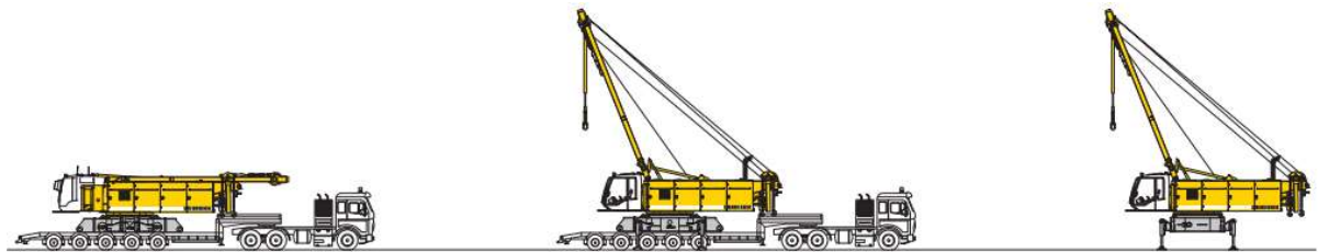
1- Transporte y soporte sobre estabilizadores
