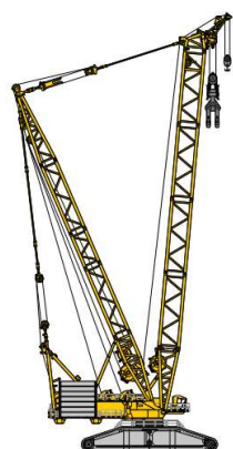
33 – carga de contrapesos máximo en estructura 750t
