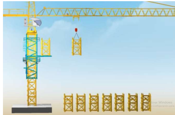
K - la altura final de la grúa dependerá de la cantidad de tramos agregados
