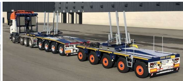
5 – Dolly de distinta configuración de ejes, cuantos más ejes posea, mayor será su capacidad de carga
