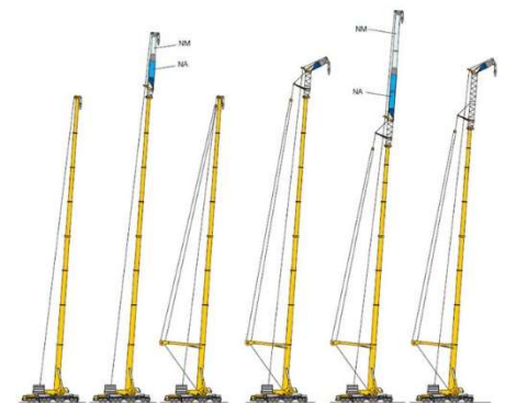
27 - Distintas opciones de pluma con extensiones y contrapesos agregados
