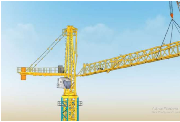
I –montaje de pluma principal, previamente ensamblada en el suelo
