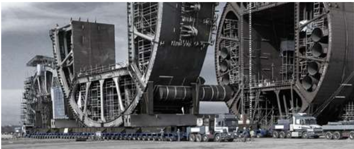
11- Vehículos modulares para carga pesada Goldhofer, autopropulsados y traccionados
