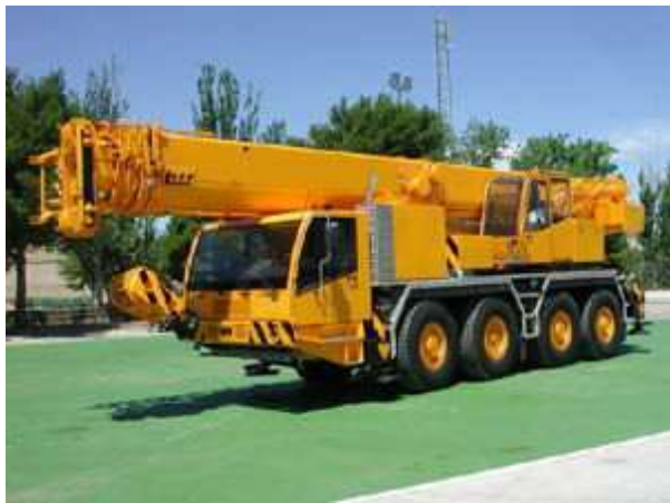
25 –Grúa AT-70/46 - Capacidad máxima: 70 t - Pluma: 46 m - Extensión: 10 - 18 m Tracción / Dirección: 8 x 6x 8 - Velocidad: 76 Km/h - Pendiente máx. Superable: 60% Contrapeso total: 9,5 t (13,5 t opcional)
