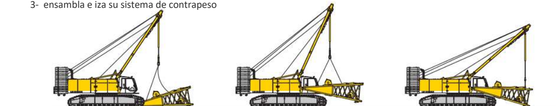
4- descarga y posiciona los tramos de la pluma para su ensamble
