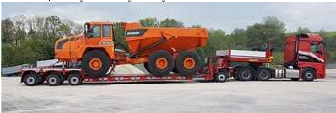
13- carretón de cama rebajada
