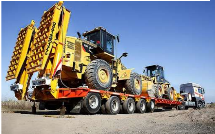
8 – por su baja altura y mayor ancho pueden transportar cargas indivisibles de grandes dimensiones
