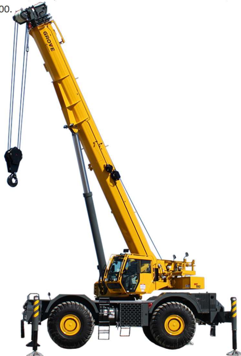
29 - Grúa Grove RT 88/S - capacidad 80t, pluma telescópica 12,6 – 41,1m, largo máximo con extensión 68m -
