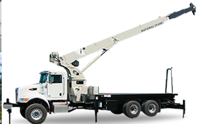
22 – grúa telescópica NATIONAL CRANE - Altura máx. de punta 36.3m - Longitud de pluma principal 33.5m Capacidad máx. 9.1tn
