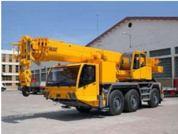
24 –Grúa Luna AT 40/32 - Capacidad máxima: 40 t - Pluma: 32 m - extensión: 8,5 - 15 m Tracción / Dirección: 4 x 4 x 4 Velocidad: 80 Km/h - Pendiente máx. Superable: 60% - Contrapeso total: 5,0 t
