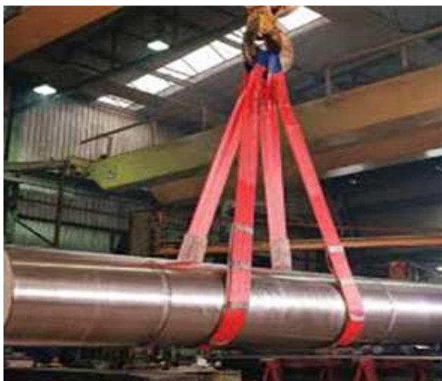
40 - eslingas planas, permiten abrazar la carga
