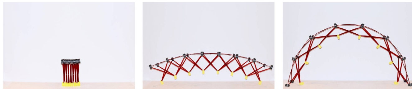
MODELOS A ESCALA DEL ARCO DESPLEGABLE USANDO MÉTODOS DE FABRICACIÓN DIGITAL
