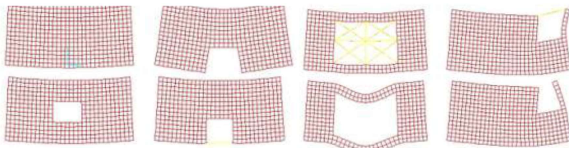
Deformación de un diafragma regular, y aparición de distorsiones debidas a perforaciones
