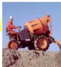
MOTOMEZCLADORA-HORMIGONERA 500 litros de capacidad
