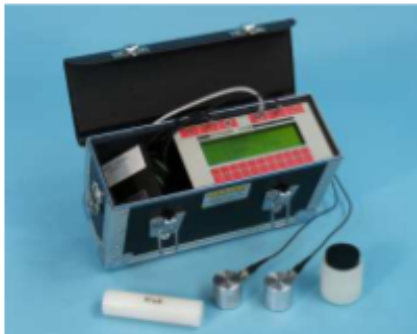
Equipos Ultrasonicos para ensayos no destructivos del Hormigón endurecido
