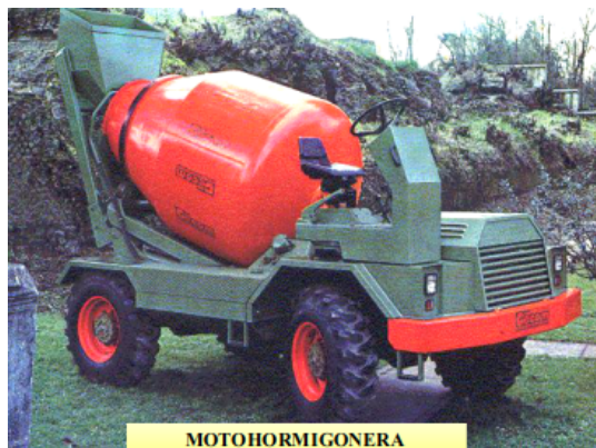
MOTOHORMIGONERA (funciona como un "mixer") 2 m 3 de capacidad
