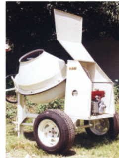
HORMIGONERA de PERA de VOLTEO 150 litros de capacidad (remolque) con motor a explosión
