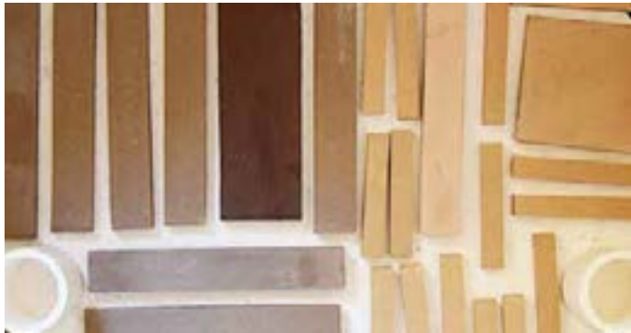
Arriba, izquierda: Para lograr los colores se utilizaron pigmentos cerámicos puros y óxidos de metales. Derecha: Parte posterior de las piezas identificadas con los nombres de las realizadoras que permitan su fácil identificación en futuras intervenciones. Abajo: Pastas de prueba de dos de los trece tonos de la paleta de colores a utilizar. Para lograr los colores definitivos se formularon más de ciento setenta recetas.
