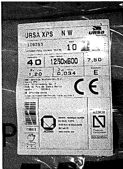
Figura 6.1. Control de recepción de los productos. Aislamiento térmico
