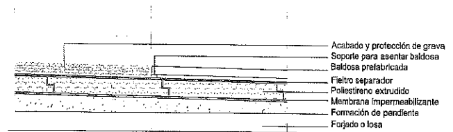
Figura 3.25. Detalle de cubierta de grava con pasillos de mantenimiento
