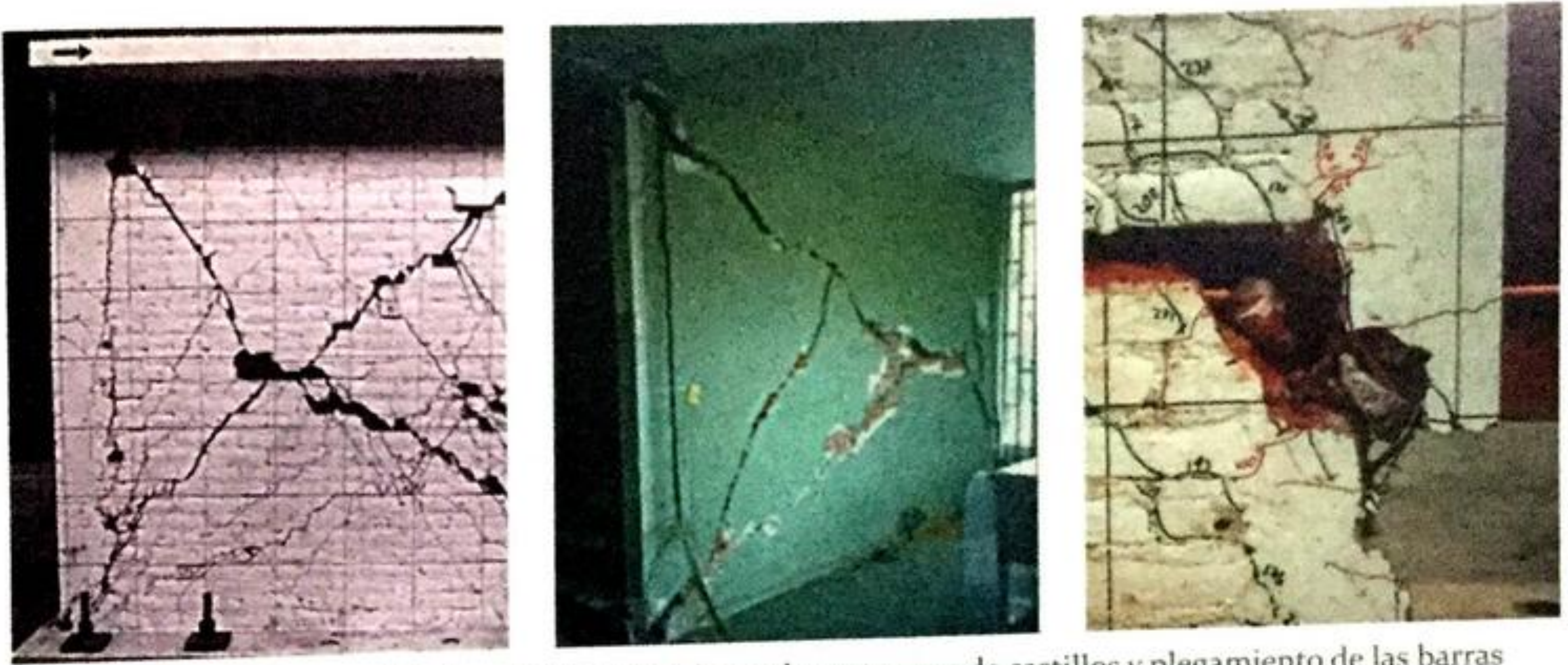
Figura 3.25 Patrón de daño ante fuerzas horizontales a distintos niveles de distorsión (Flores, 1995)
