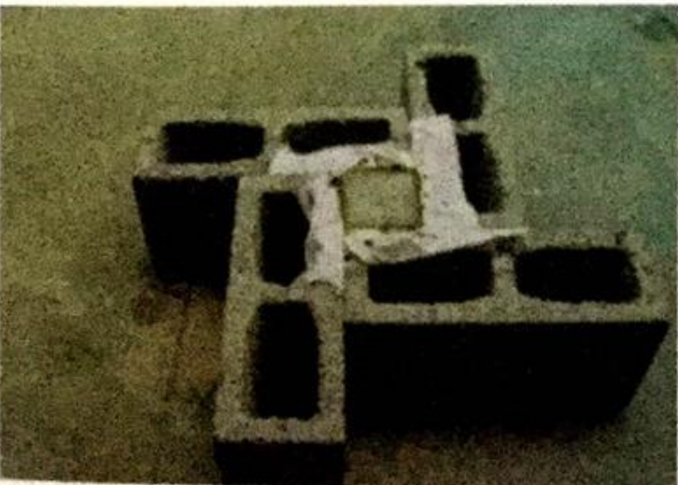
Figura 2.25 Probeta de mortero de relleno: terminada.
