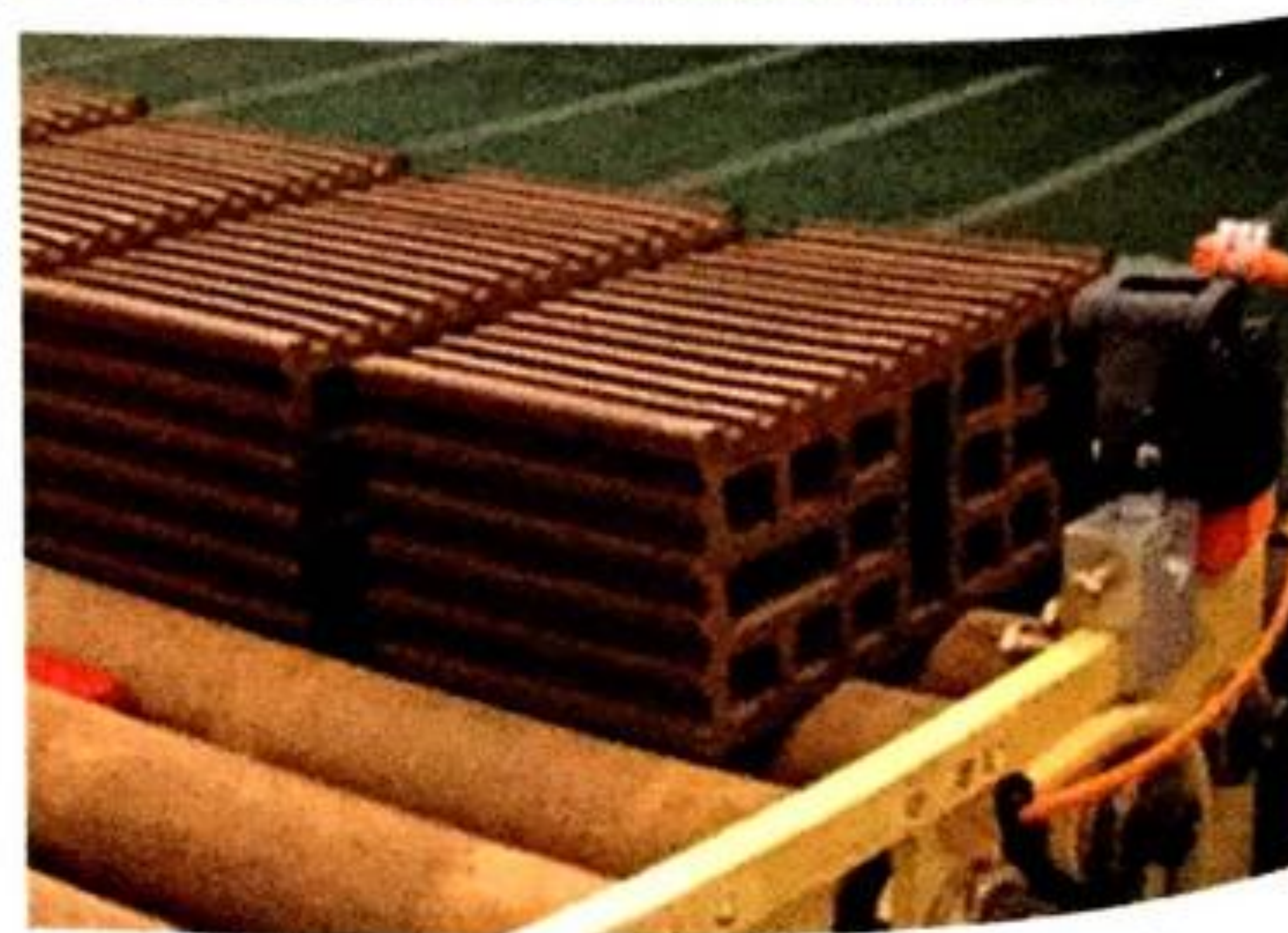
Figura 2.13 Extrusión y geometría de piezas.
