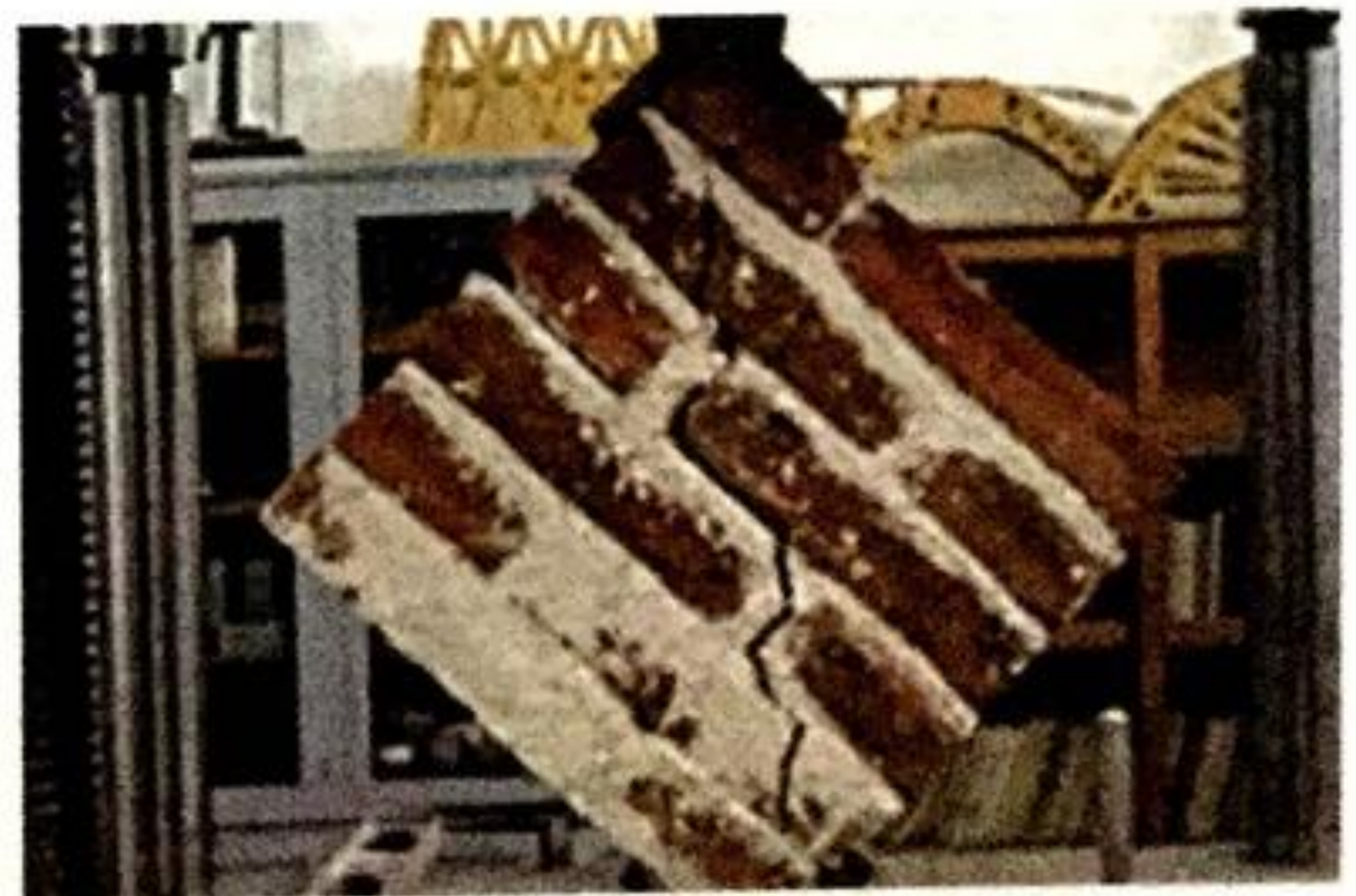
Figura 2.38 Mecanismo de falla combinado.
