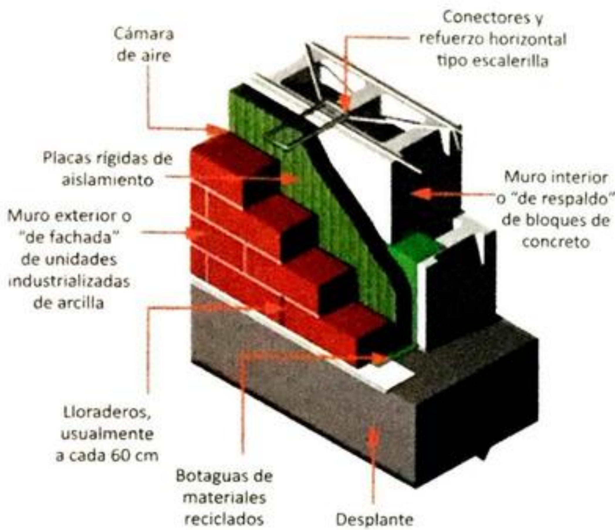
Figura 1.13 Muro de dos hojas, muy utilizado en Estados Unidos y Canadá ( Cavity Wall , en inglés).
