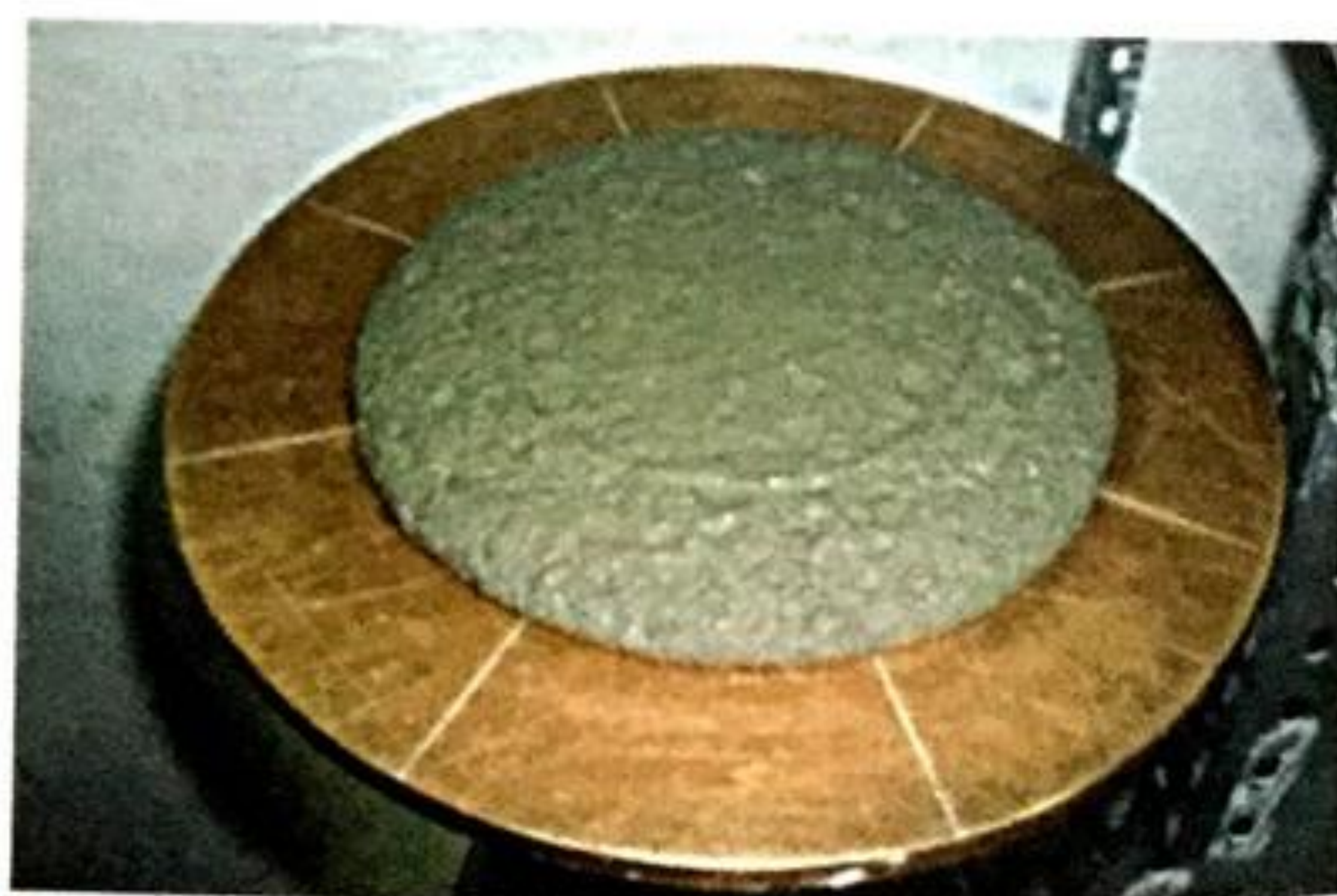
Figura 2.22 Muestra de fluidez después de los impactos.
