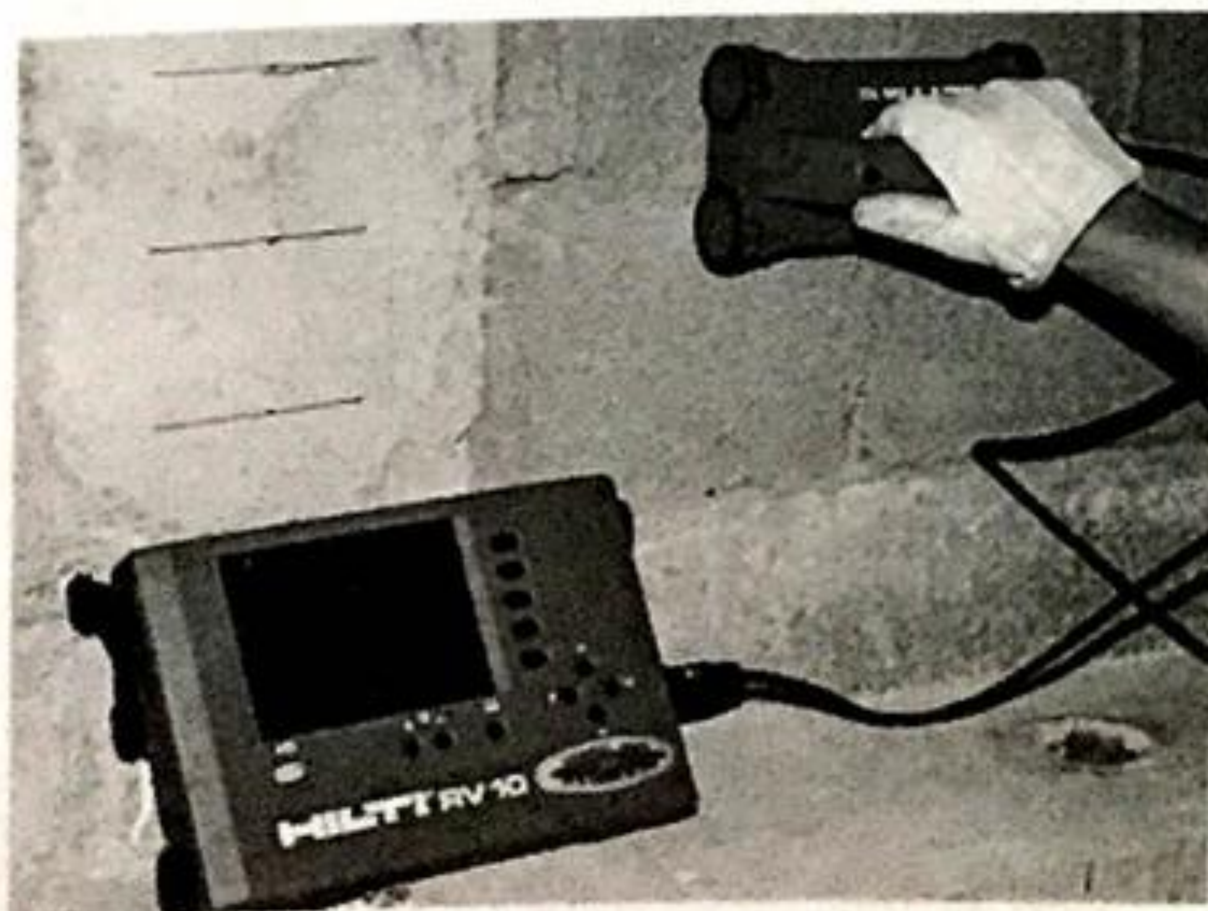
Figura 10.8 Moderno equipo para localizar barras de acero y determinar su diámetro y profundidad.
