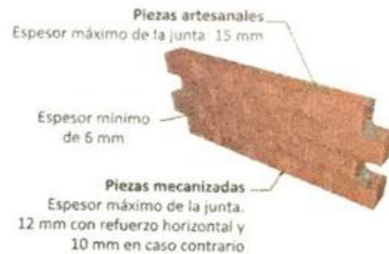
Figura 8.24 Espesores de juntas de mortero.
