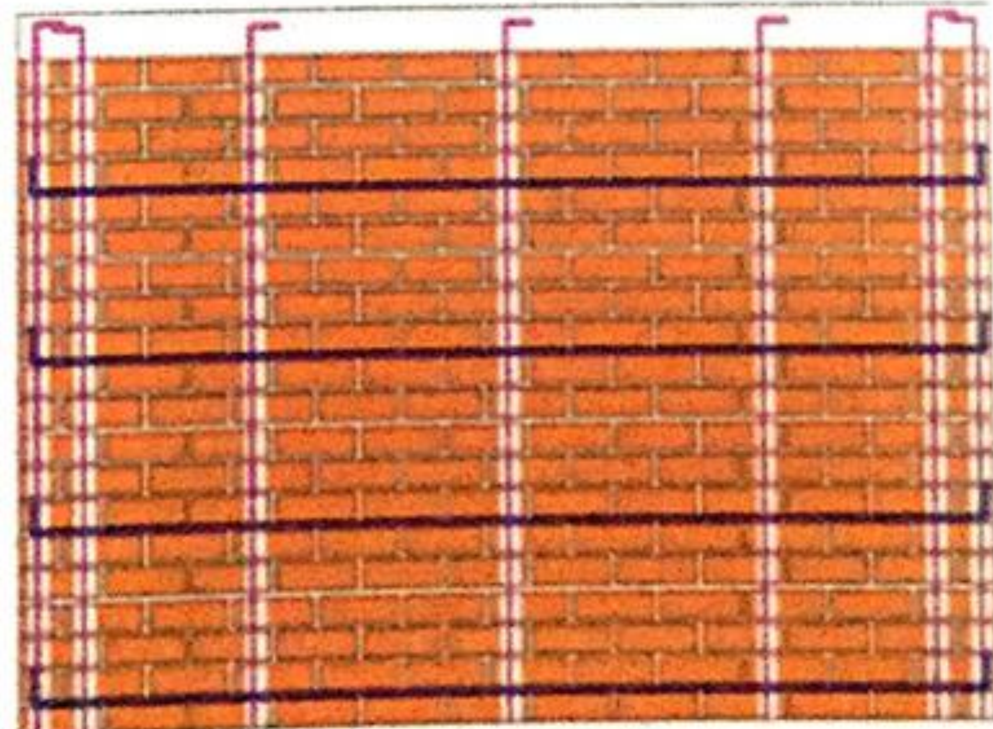
Mampostería reforzada interiormente
