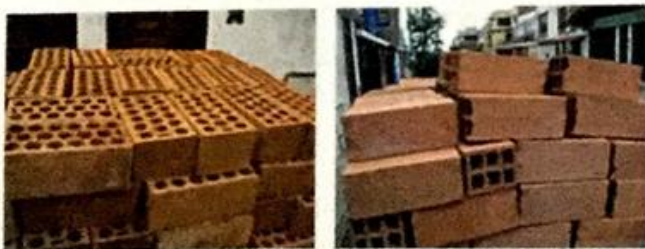
Figura 13.2 Unidades industriales de arcilla para muros estructurales (izquierda) y no estructurales (derecha).
