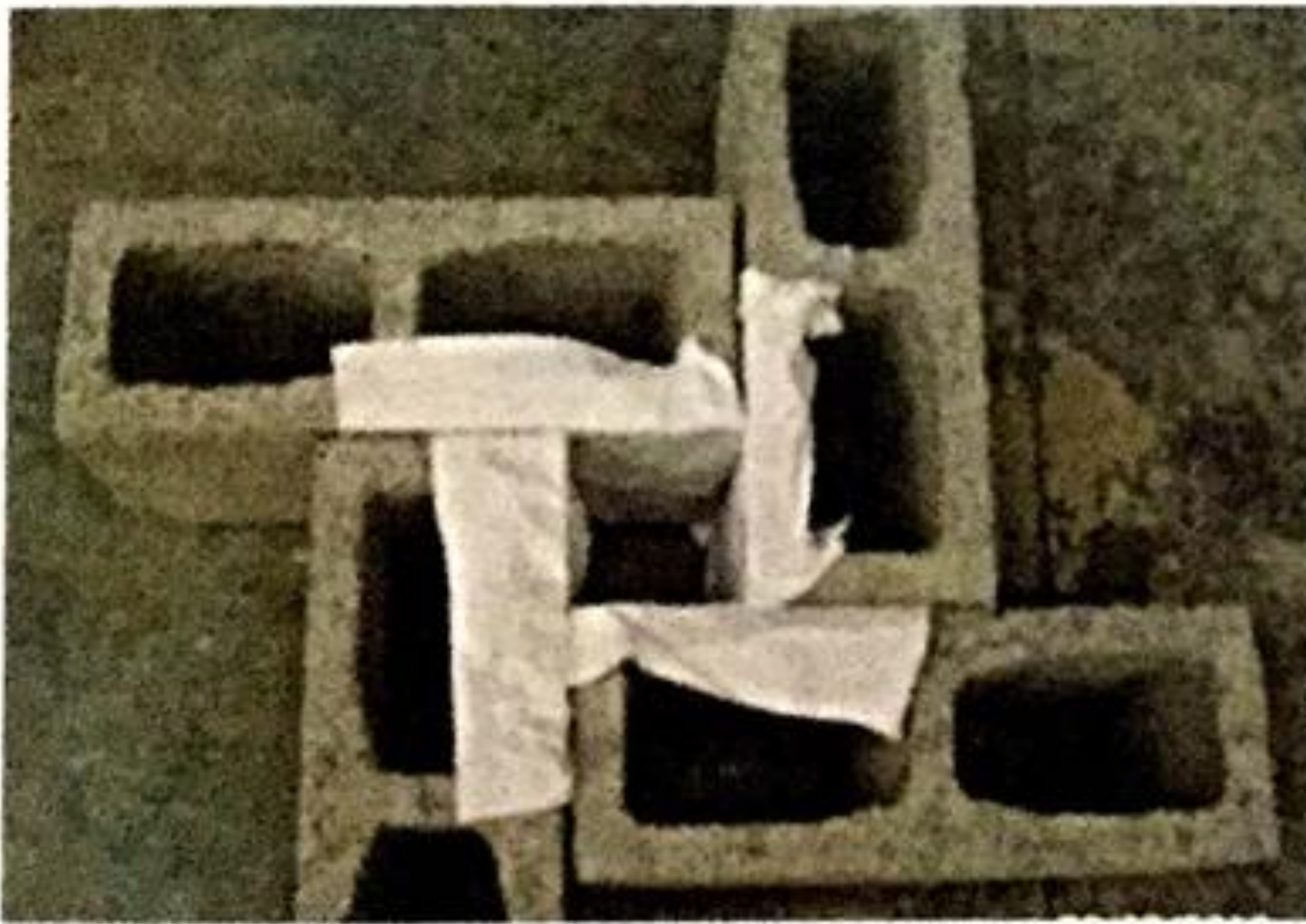
Figura 2.24 Probeta de mortero de relleno: preparación.
