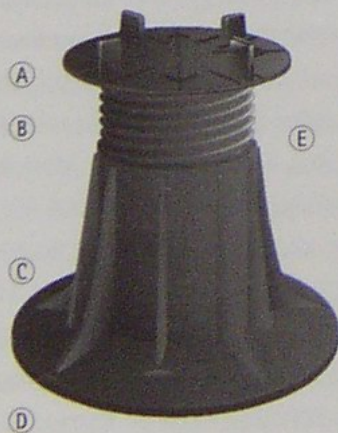
Soporte SRE: A. 120 ø; B. Cilindro de rosca ø 75 mm; C. Base de ø 170 mm; D. Indicador de máxima pendiente; E. Nervaduras de refuerzo. Altura máxima 600 mm. Resistencia a compresión >2.000 Kg.
