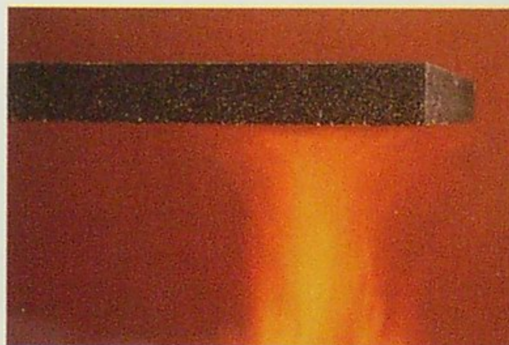
La naturaleza del vidrio celular dota a las placas de este material de una alta resistencia al fuego.
