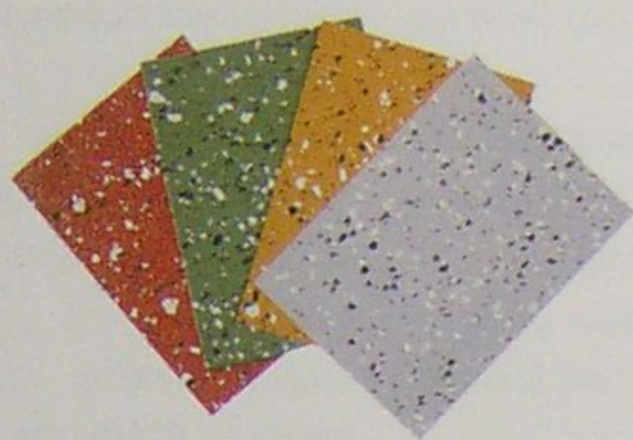
Impermeabilizantes decorativos que incorporan chips vinílicos (partículas de pintura).
