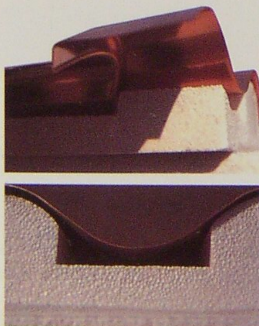
Imagen lateral y frontal del panel Tegostil® Compact. La variación de sección del aislante se utiliza como canal de ventilación de condensaciones.
