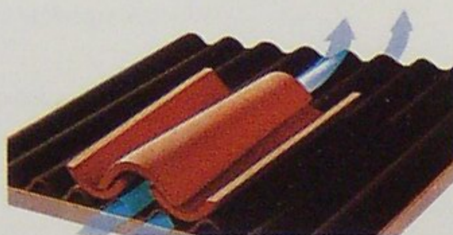
Onduline Bajo Teja proporciona ventilación bajo las tejas y bajo las placas.
