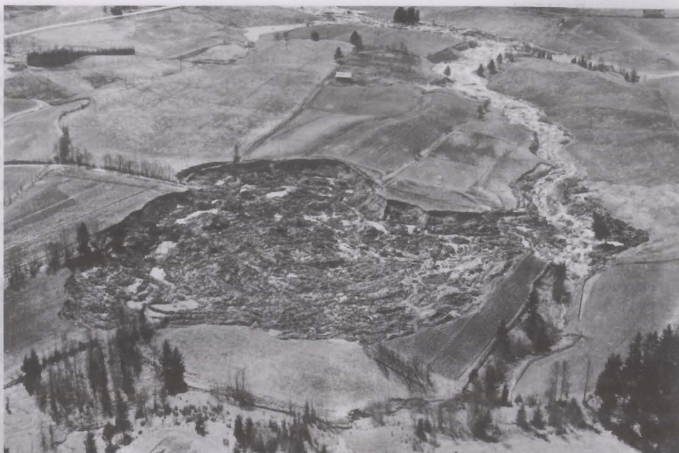
Fig. 1.13. Deslizamiento en arcilla marina muy sensible ( quick clay ) (cortesía de Laurits Bjerrum).
