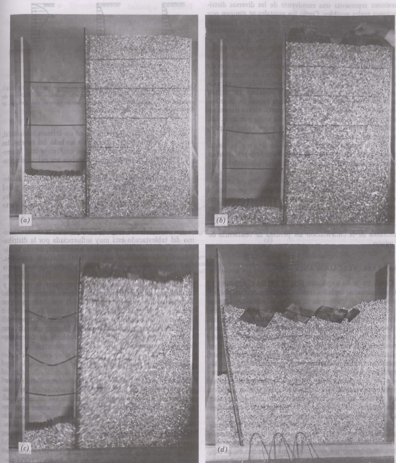
Fig. 13.30. Falla de un modelo de excavación entibada. a) Situación estable. b) A punto de fallar. c) En la falla; adviértase el movimiento del 'terreno'. d) Después de la falla.
