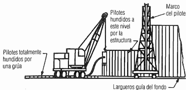
Figura 10.18. Hundimiento típico de pilotes en dos etapas.
