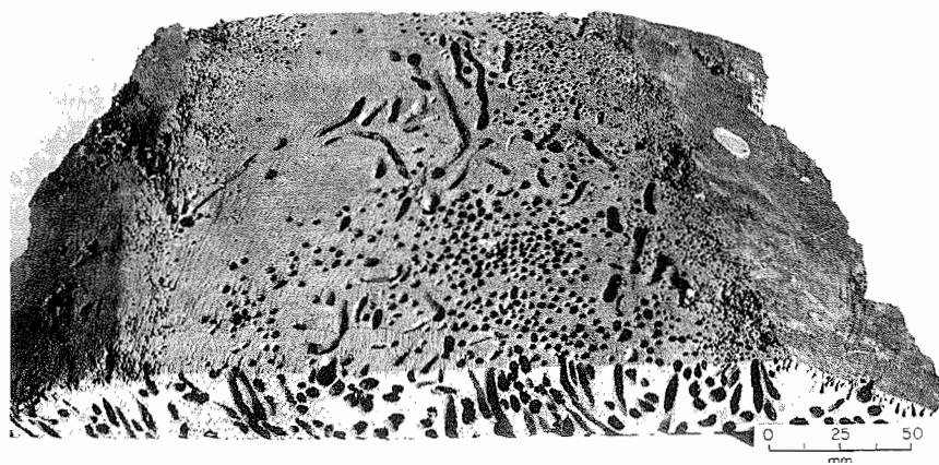
Figura 13.1. Ataque de Teredo en madera. (Crown Copyright reproducida con el permiso de BRE, Princes Risborough Laboratory.)
