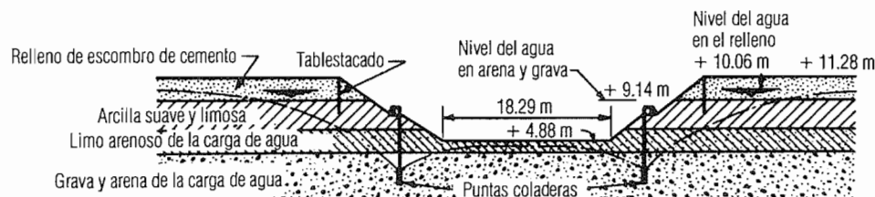
Figura 11.18. Instalación de la punta coladera para toma de la casa de bombas de la estación de energía del Ferry bridge "B".
