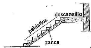
Fig. 21.2 Partes principales de una escalera.
