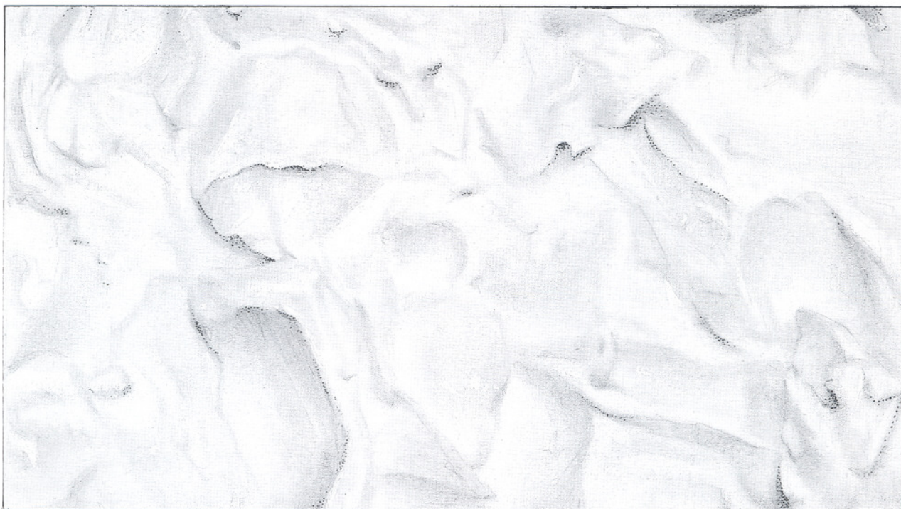
15. Textura y densidad de la cal obtenida después de 180 días de reposo.
