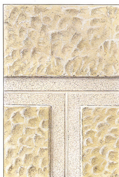
7. Textura de los falsos sillares escodados con atacaduras labradas y junta de punzón.
