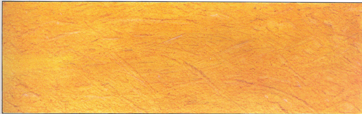
20. Textura de la segunda capa tras el repretado.
