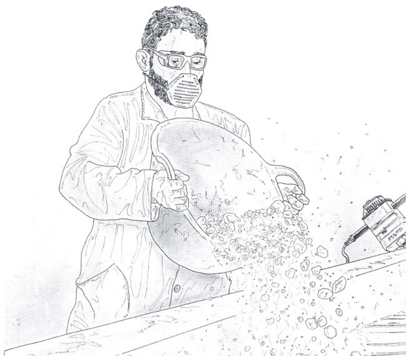
4. La cal viva al entrar en contacto con el agua desprende vapor.
