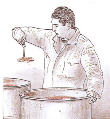
14. Antes de tamizar se comprueba el tono de cada barril.
