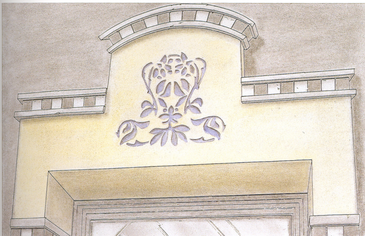
18. Detalle del esgrafiado de fondo labrado y superficie enlucida.
