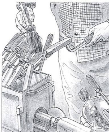
7. Limpieza del hierro al extraerlo del fogón.
