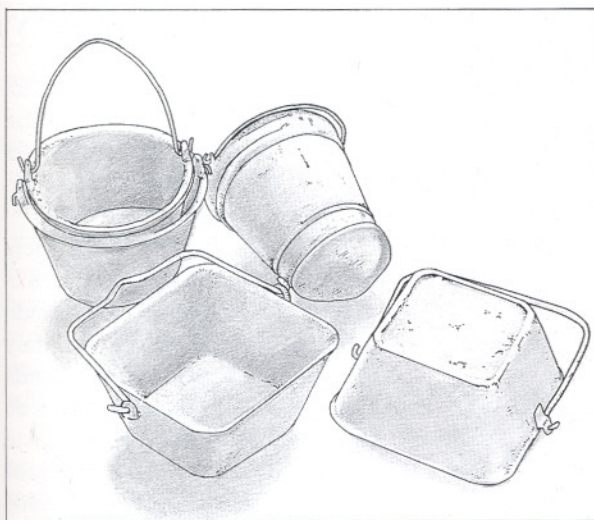
3. Espuerta de goma, gavetas y cubos metálicos.
