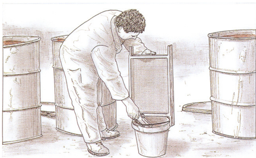
15. El tamiz se moja con agua para que no se incruste la cal teñida.
