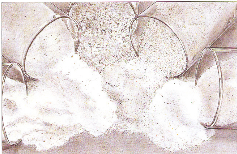
1. Áridos de mármol de 0'35, 0'8, 1'5 y 2'5 mm.
