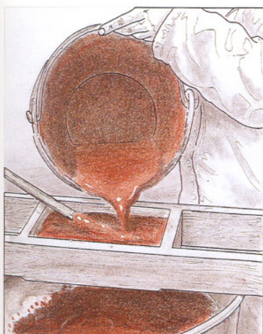
6. Tamizado del pigmento con agua sobre el bidón de cal.
