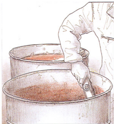
12 y 13. Con la paleta y el cepillo mojado se limpia el borde interior del bidón.
