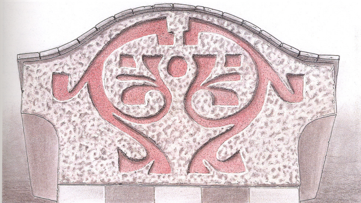
8. Vista del esgrafiado de fondo labrado en rojo y de la textura del estuco escodado de superficie.
