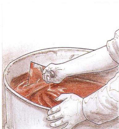
12 y 13. Con la paleta y el cepillo mojado se limpia el borde interior del bidón.
