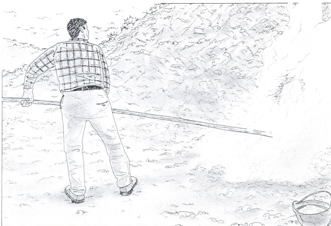
8. Con un largo atizador se aviva el fuego de la cocción.
