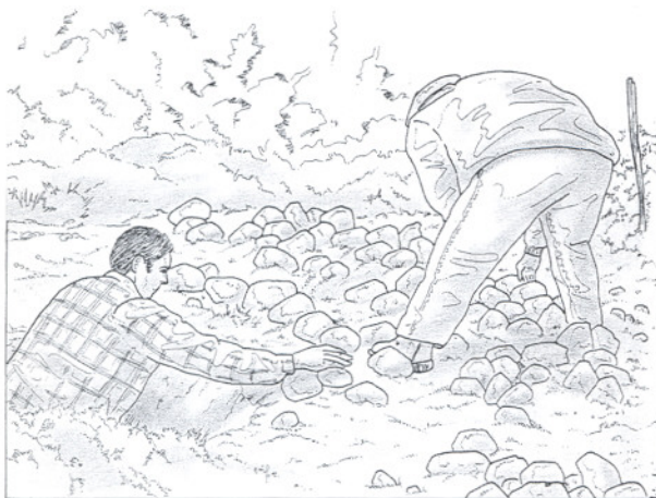
6. Carga del horno con piedra caliza desde el exterior.
