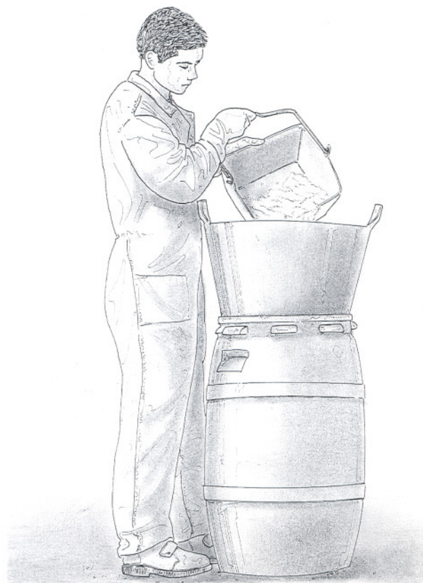
2. Tamizado de la cal ya apagada y fría.
