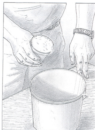
7. Incorporación de una medida de talco a la mezcla.
