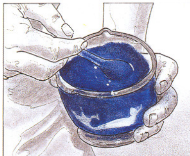
1 y 2. En morteros de cristal se mezclan dos tipos de pigmentos con la cal, en una proporción de color del 5%.
