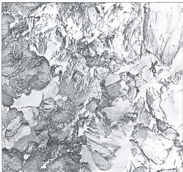
2. Vista microscópica de una pasta de cal recién apagada, con cristales demasiado grandes y agrupados y, por lo tanto, poco plástica.
