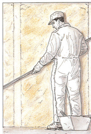
16 y 17. El paramento se recorre horizontal, vertical y oblicuamente para nivelar la masa del cajón.
