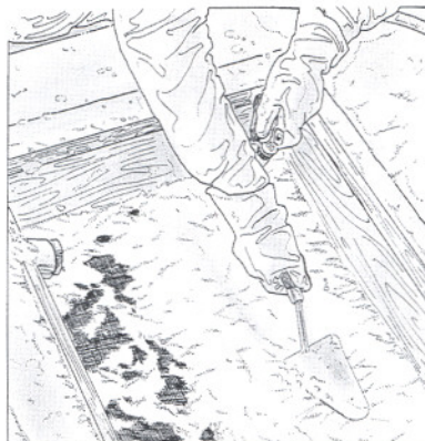
12. Con la paleta catalana se comprime la mezcla contra el tamiz.
