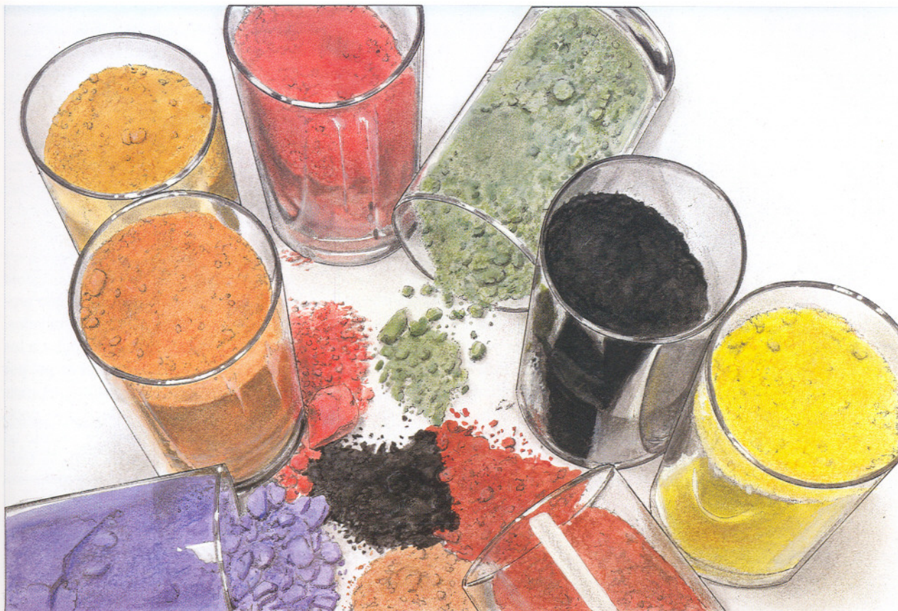
1. Diversos tipos de pigmentos: azul cobalto, verde óxido de cromo y óxidos de hierro de diferente tonalidad (rojo, amarillo, pardo, marrón y negro).
