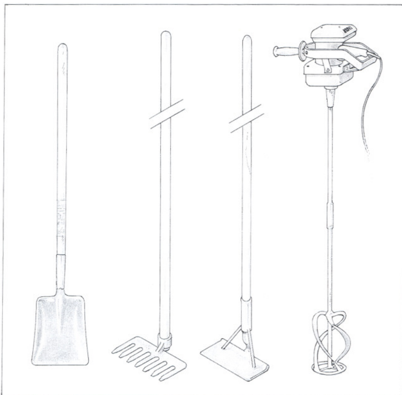
2. Pala cuadrada, rastrillo, batidera manual y batidora eléctrica. Esta última sólo se debe emplear para el apagado de la cal en bidón. No utilizar en la balsa de apagado por peligro de descarga eléctrica.
