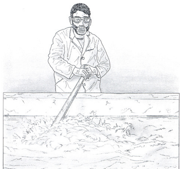
10. Se remueve la cal para que no se deposite en el fondo.
