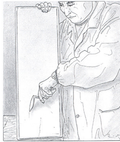
3. Prueba de mortero con la dosificación correcta. La masa no se cuarteada y es suficientemente resistente. Después de 24 horas, la paleta no penetra en el mortero.
