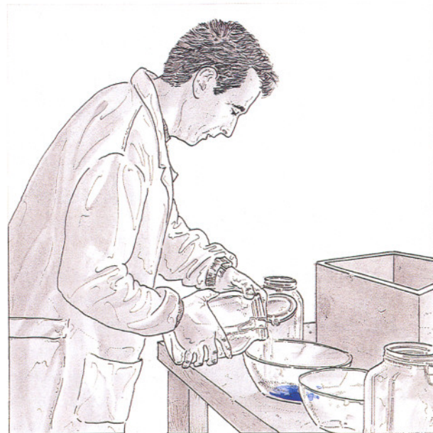
2. Diluido del pigmento con agua de cal.
