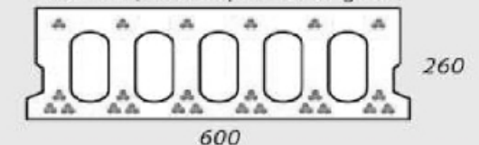
LOSA L26 (Peso Propio = 320 Kg/m 2 )
