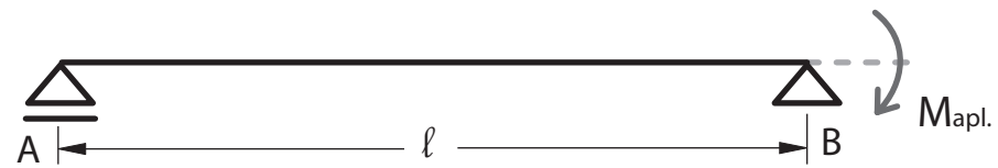
[Figura 40] Esquema de carga de viga simplemente apoyada y momento aplicado
