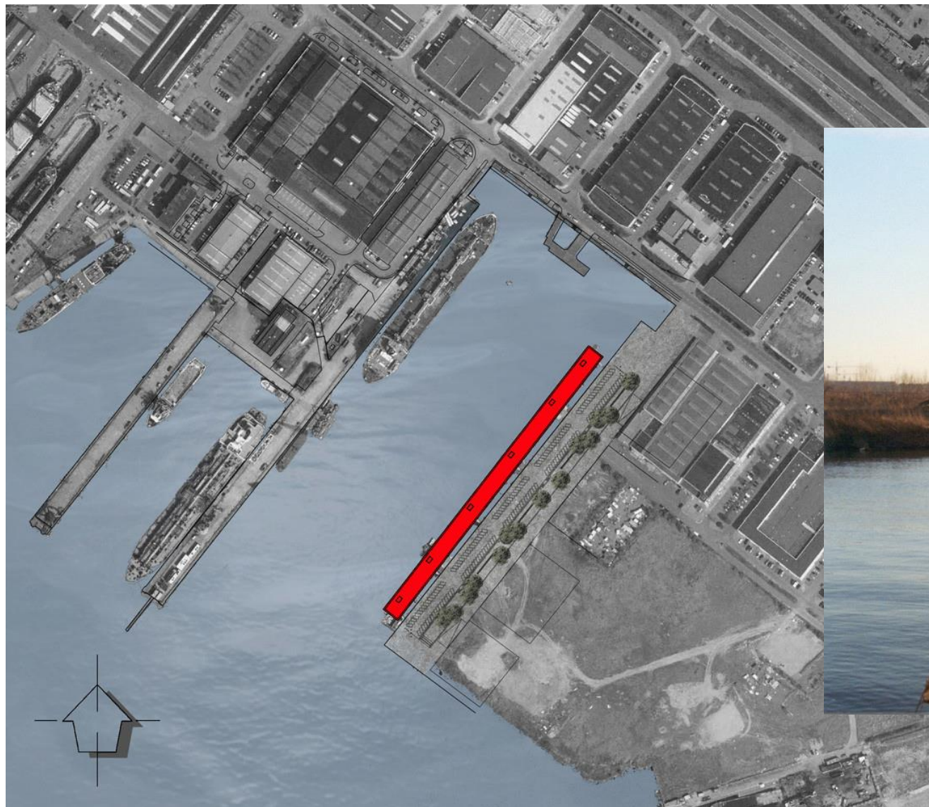
Monumento industrial, construido en 1952, en hormigón armado, con una longitud total de 270 metros, una altura de 13,5 metros y una ancho de 8,7 metros, en la costa de Amsterdam sobre el río IJ.
